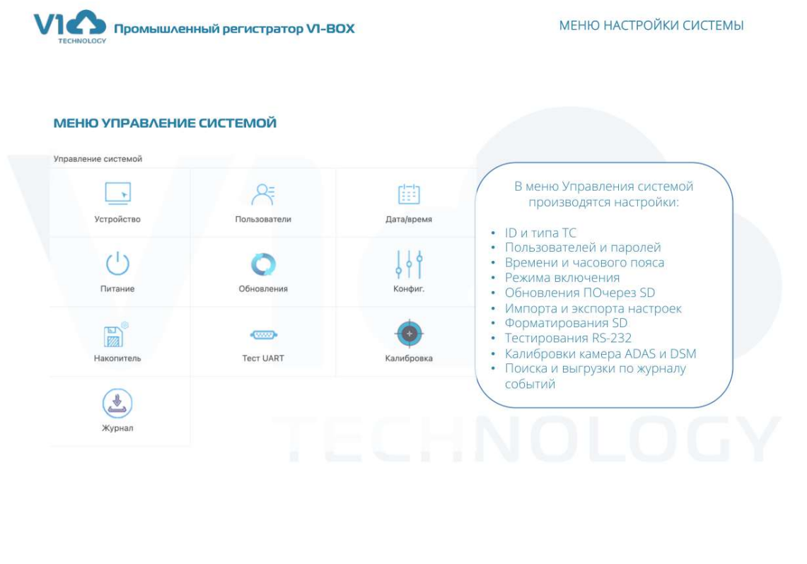
Меню управления системой: ID, пользователи, время, питание, импорт/экспорт, форматирование SD, калибровка ADAS/DSM
